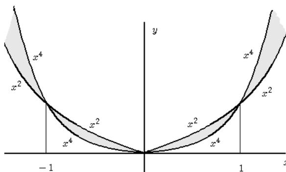
Nella figura la parte scura rappresenta i punti in cui  $f(x, y) < 0$ . In ogni intorno di  $(0, 0)$  ci sono punti in cui  $f(x, y) > 0$  e punti in cui  $f(x, y) < 0$ . Dato che  $f(0, 0) = 0$ , ne segue che  $(0, 0)$  è un punto di sella, contrariamente a quanto si poteva dedurre analizzando la funzione lungo tutte le rette passanti per l'origine.
