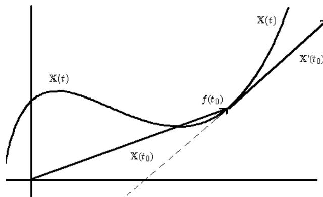
Come illustrato in figura nel caso di una  $f : \mathbb{R} \rightarrow \mathbb{R}^2$ , se vogliamo scrivere l'equazione della **retta tangente** alla curva  $\mathbb{X}(t)$  nel punto  $f(t_0) = \mathbb{X}(t_0)$ , occorre anzitutto portarsi nel punto di tangenza con il vettore  $\mathbb{X}(t_0)$  per poi, moltiplicando per lo scalare  $t$ , generare tutti i punti che stanno sulla retta avente la direzione di  $\mathbb{X}'(t_0)$ .
